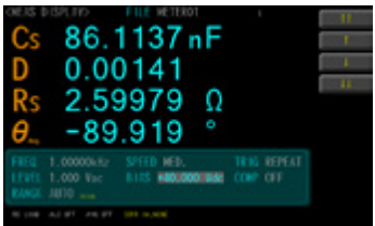
施加 40V DC Bias 電壓，電容值下降至 86.11nF
