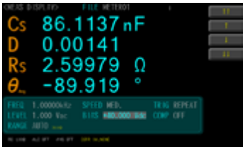
多步列表：施加不同 DC Bias 電壓量測出電容值變化
