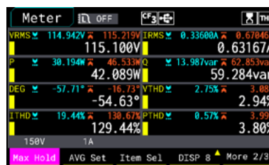
Simultaneous Display of 8 Parameters
