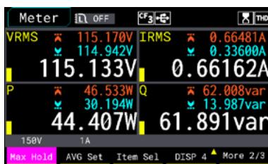
Simultaneous Display of 4 Parameters
