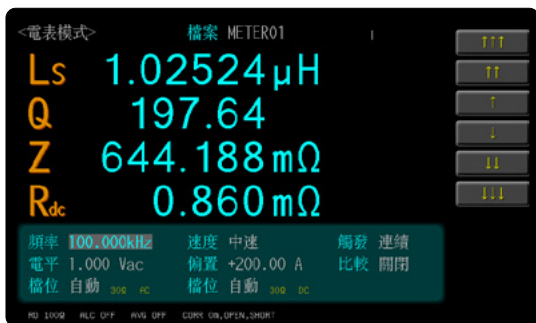
對電感施加200A，電感量降至1.02 \mu\text{H}
