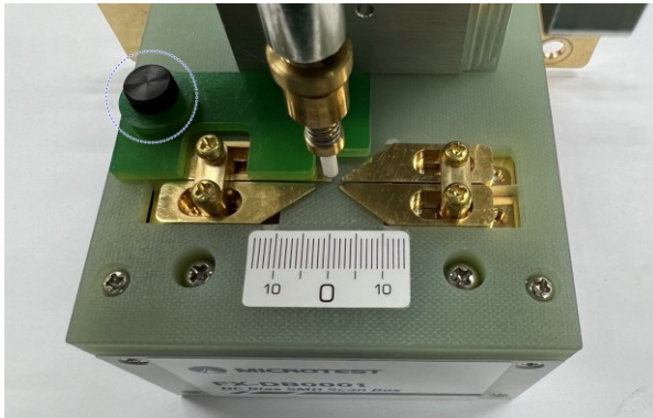
圖 1-3-1 拆除定位片板
