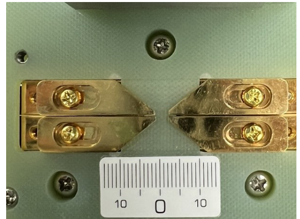
圖 1-4-2 調整測試片距離並鎖上螺絲
