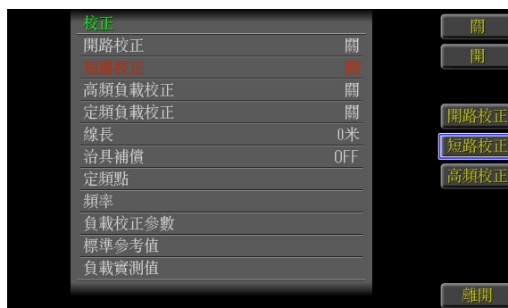
圖 圖 3-1-6 執行短路校正
